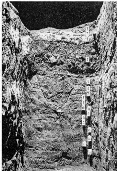
薬師堂(推定・金堂跡)下からあらわれた版築層(撮影・提供 小池汪)
